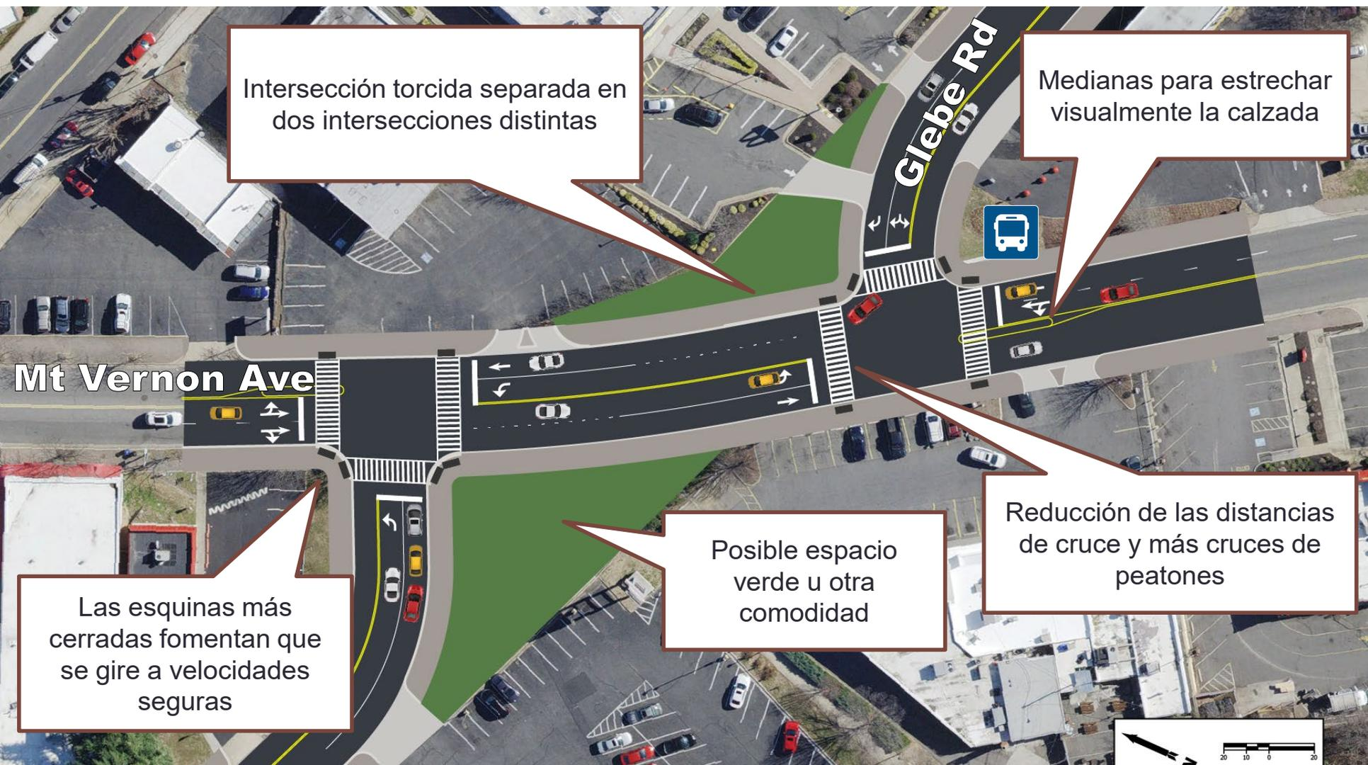
Intersección torcida separada en dos intersecciones distintas
